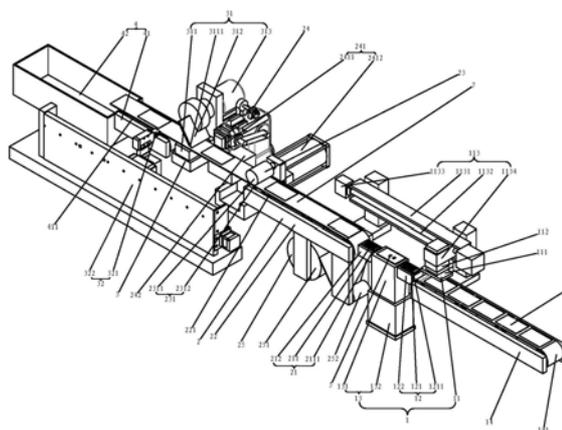
1. 一种自动化贴标流水线,其特征在于:包括将商标单体的上表面和塑料膜单体的下表面连接形成第一连接体的第一连接装置,将第一连接体连接于连接带上表面形成第二连接体的第二连接装置,将第二连接体裁切成连接体单体的裁切装置,以及对连接体单体进行收纳的收纳装置。所述第二连接装置包括对第一连接体的下表面施胶的第一施胶装置,传输连接带和第一连接体的第一输送装置,对连接带和第一连接体进行压合的压合装置,以及将第一连接体缝纫于连接带上的缝纫装置。
